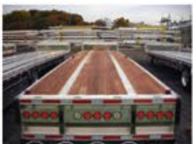
Opción de plataforma de madera de apitong con bloques para contenedores
