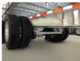
AANL-230 con 250 bolsas de aire y sistema sellado de extremo de ruedas HXL-5 de Hendrickson (garantía de 5 años). Barras de suspensión y refuerzo galvanizados
