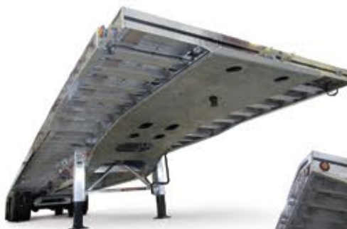
MLP-6 La placa del acoplador de aluminio de 1/2" se extiende hasta la transición del cuello.
